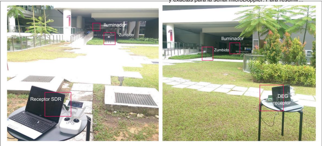
Figura 4. Configuración del experimento para la firma micro Doppler.
