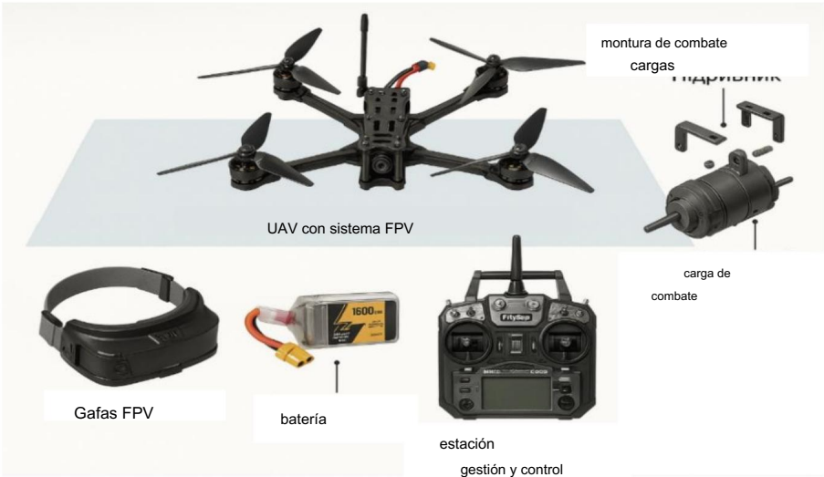
Figura 1 – Composición típica de un UAV multicóptero con un sistema FPV
