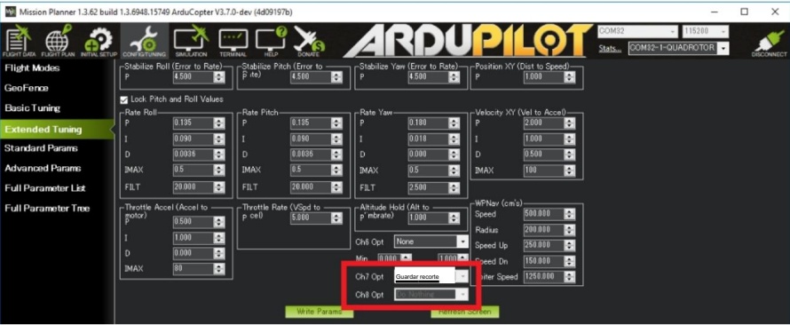
Figura 18 – La ventana “Ajuste extendido”, que vincula la función “Guardar ajuste” a 7- canal mu
