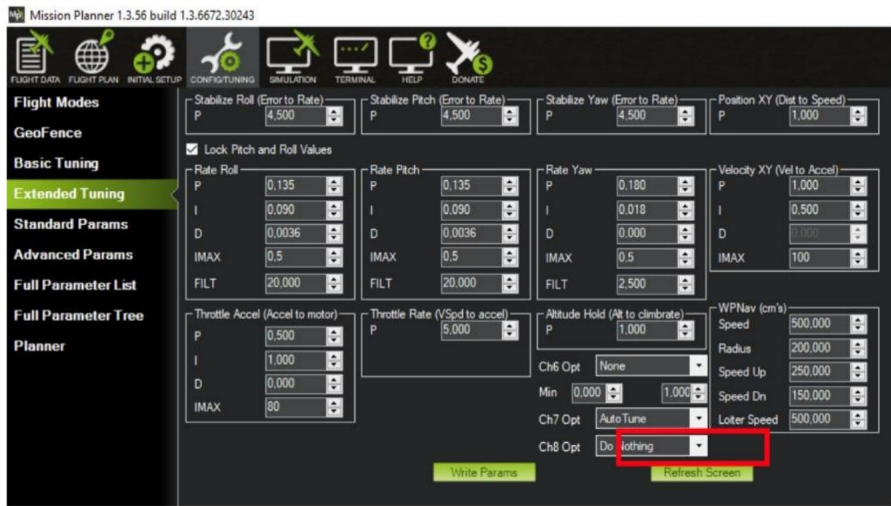
Figura 17 – La ventana “Sintonización extendida” y la función “Auto Tune” vinculada a 7-canal mu
