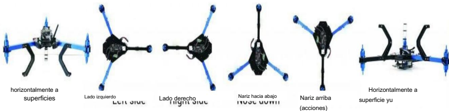
Figura 16 – Rotación del UAV para calibrar la brújula
