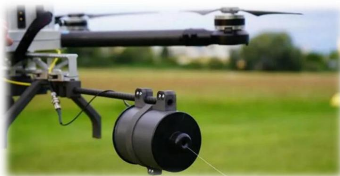
Figura 1 – Aspecto de un UAV controlado por fibra óptica
