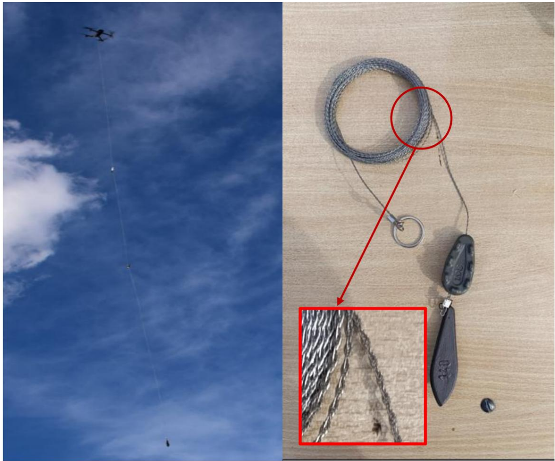
Figura 3 – Aspecto del Mavic 3T con una sierra de alambre en el aire (izquierda) y la sierra de alambre (derecha) antes de la instalación
