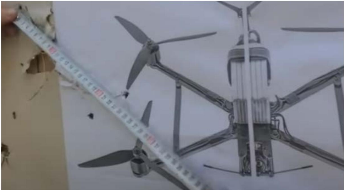
Foto 20. Mostrando la apertura de elementos impactantes a una distancia de 10 metros (hace 22 centímetros)
