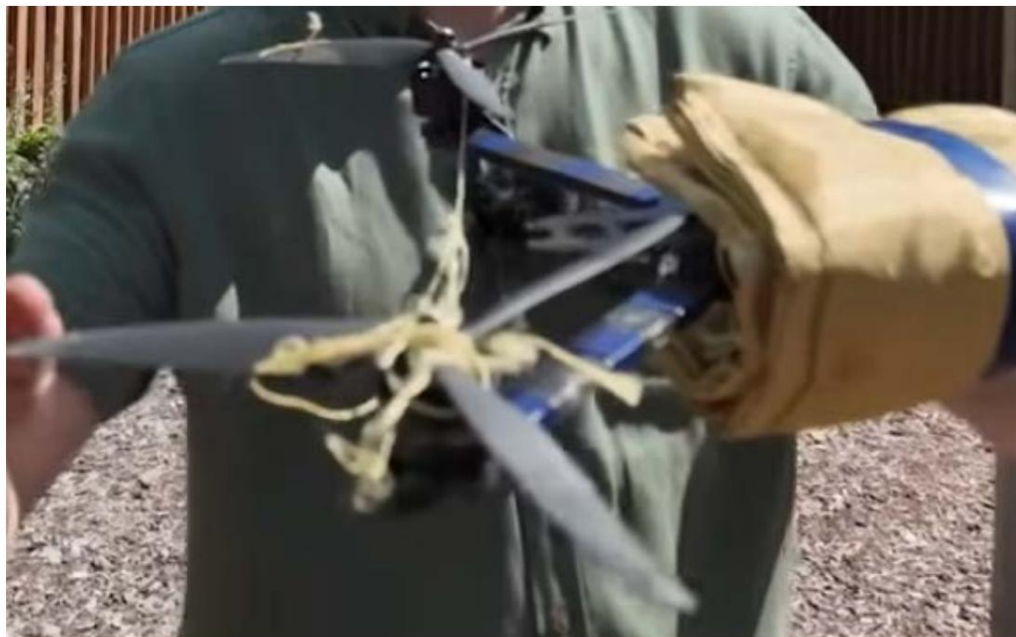
Foto 26. El resultado de que el dron fue golpeado por bala "CAESURA" (Kevlar a 140 m/s un hilo enredó las aspas del dron y la aspa se desprendió del hilo)
